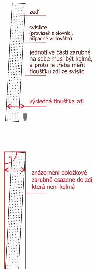
Zárubeň je na základě správně naměřených rozměrů připravena na to, že zed' nestojí zcela kolmo, a zbyvající prostor mezi zárubní a zdí vyplní akrylátový popr. štukový tmel nebo úprava omítky.
